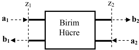
Şekil 2. Birim hücrenin kapılarındaki saçılma parametrelerinin tanımlanması
