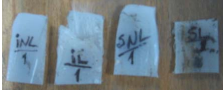
Şekil 11. Endirekt ısıtılmış lifli ve lifsiz optik mikroskop içyapı görüntülemesine hazır numuneler
