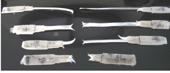
Şekil 10. Çekme deneyleri sonunda kopmuş numuneler
