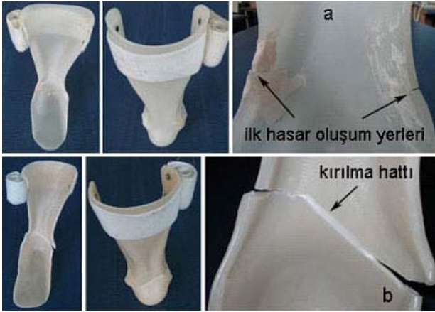
Şekil 1. Polietilen AFO ortez 'de hasar oluşumu (a) ve kırılma(b)
