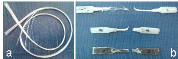
Şekil 4. Çekme deneyi sonrası Polietilen lifli ve liffsiz ile saç malzeme
