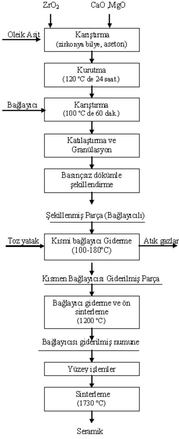
Şekil 1. Basınçsız sıcak şekillendirmeyele üretilmiş seramiklerin üretim akış şeması
