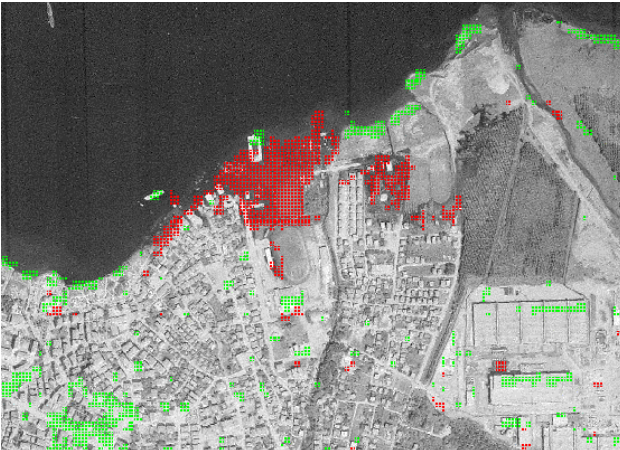
Şekil 7. Pankromatik modda tespit edilen çöküntü ve hasar alanları
