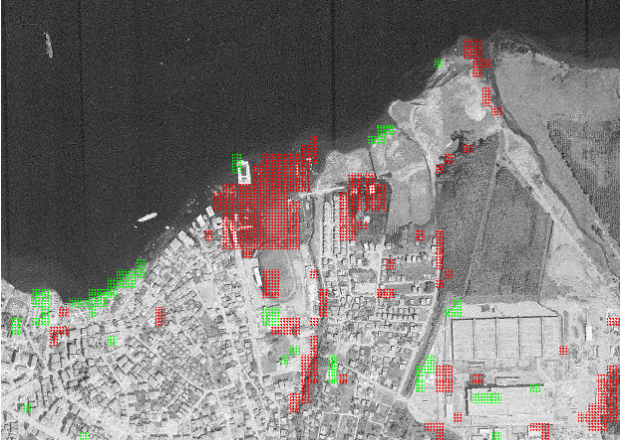
Şekil 6. Asal bileşen analizi ile multispektral modda tespit edilen çöküntü ve hasar alanları
