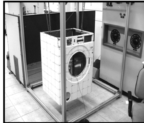
Şekil 4. Gövde deneyel modal analiz düzeneği
