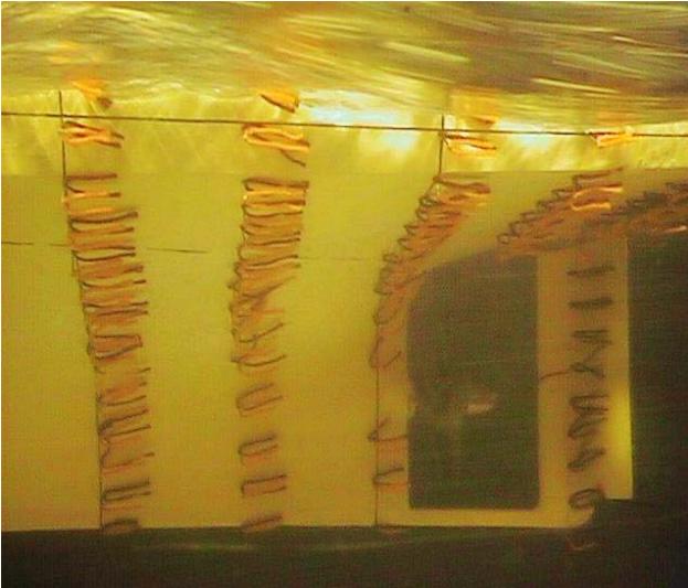
Şekil 3. Yükleme Durumu: Yüklü (1.00xT), Akım Potansiyometresi=110 ( V_s=8 knot), Pervane Potansiyometresi=0 ( RPS_s=0 ) olan deney koşullarındaki kış taraf ve baş taraf iplikçikleri ( Rn_m=3.35 \times 10^6 )
