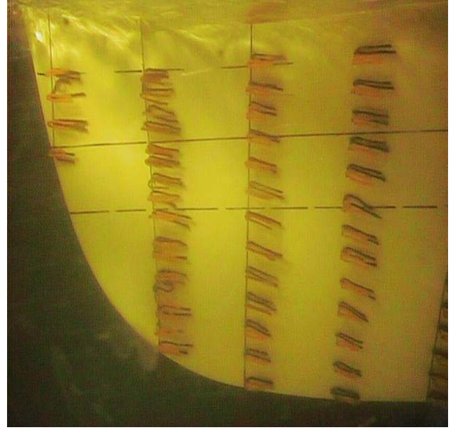
Şekil 6. Yükleme Durumu: Aşırı Yüklü (1.25xT), Akım Potansiyometresi=110 ( V_s=8 knot), Pervane Potansiyometresi=55 ( RPS_s=11.2 ) olan deney koşullarındaki kış taraf ve baş taraf iplikçikleri ( Rn_m=3.40 \times 10^6 )
