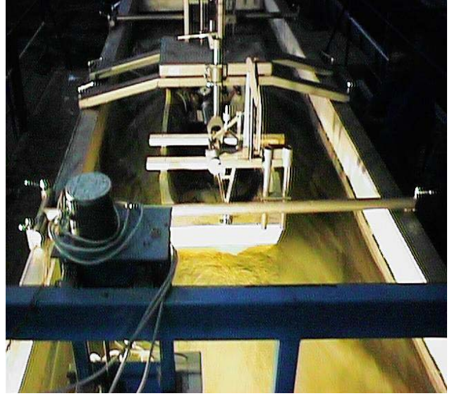
Şekil 2. Sirkülasyon kanalındaki 148/1C kodlu modelin üst-önden ve üst-kıçtan görünüşleri
