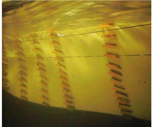
Şekil 3. Yükleme Durumu: Yüklü (1.00xT), Akım Potansiyometresi=110 ( V_s=8 knot), Pervane Potansiyometresi=0 ( RPS_s=0 ) olan deney koşullarındaki kış taraf ve baş taraf iplikçikleri ( Rn_m=3.35 \times 10^6 )
