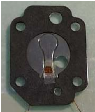
Şekil 13. Emme valf yaprağına SG yapıştırılmasına örnek uygulama
