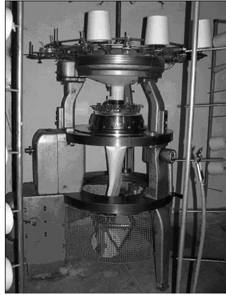
Şekil 1. Mayer & Cie. Marka 14 pus / 20E (2*876 iğne), 14 sistemli interlok örme makinesi
