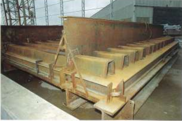
Şekil 17. Baskül köprü tabliyesi montajdan sonra tabliye sektörü
