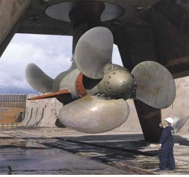
Şekil 3. Gemiye bağlanmış ikiz pervaneli ve yan kanatçıklı podlu bir pervane
