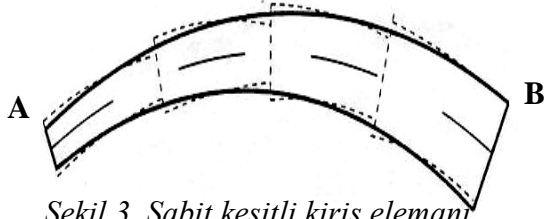
Şekil 3. Sabit kesitli kiriş elemanı ile modellenen asimetric çubuk
