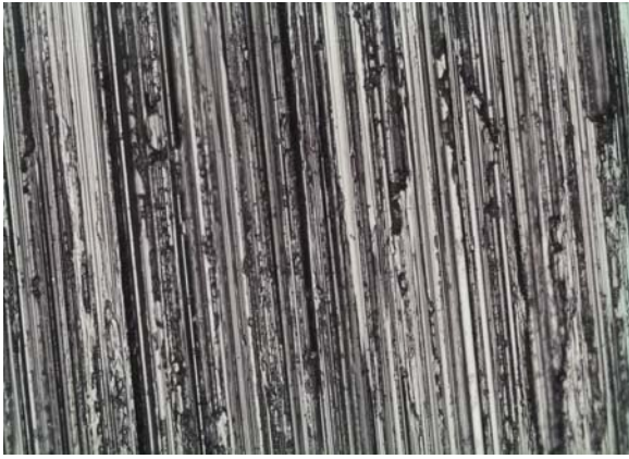
Şekil 10. R_a = 1.37 \mu\text{m} için deney öncesi disk yüzeyinin optik mikro fotoğrafı (x200)
