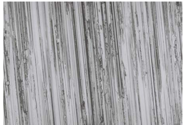
Şekil 8. R_a = 0.60 \mu\text{m} için deney öncesi disk yüzeyinin optik mikro fotoğrafı (x200)
