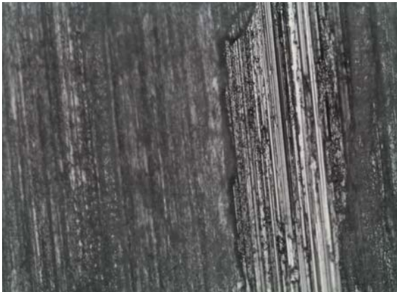
Şekil 11. R_a = 1.37 \mu\text{m} için deney sonrası disk yüzeyinin optik mikro fotoğrafı (x200)
