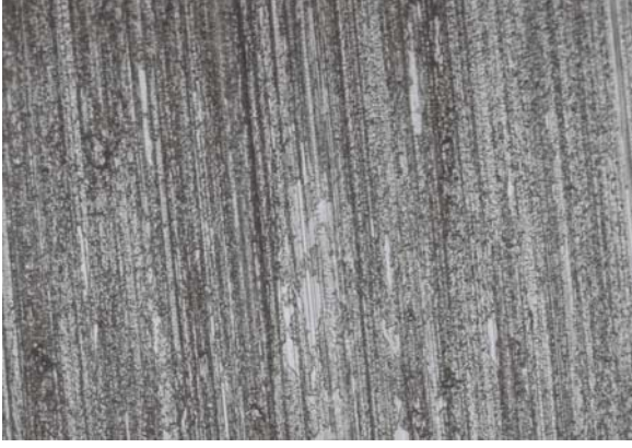
Şekil 9. R_a = 0.60 \mu\text{m} için deney sonrası disk yüzeyinin optik mikro fotoğrafı (x200)
