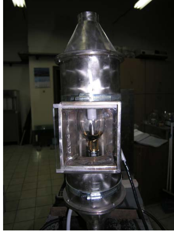
Şekil 1. Fotokimyasal proseste kullanılan yüksek akımlı Hg lamba sistemi
